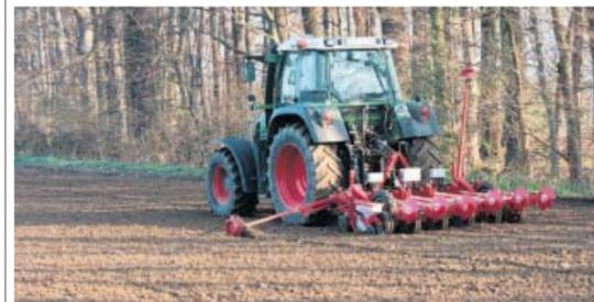
Zeit für Rüben: Mit speziellen Einzelkornsäegeräten wird jedes Rübensaatgut in einem Abstand von 20 cm hintereinander und mit einem Abstand von 45 cm zur Nachbarreihe gelegt.
